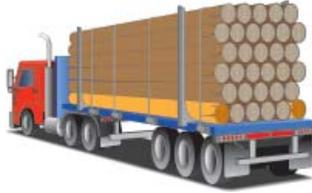
Les grumes extérieures d'une pile doivent être retenues ou être en contact avec **au moins deux (2) traverses-berceaux, traverses ou poteaux**
