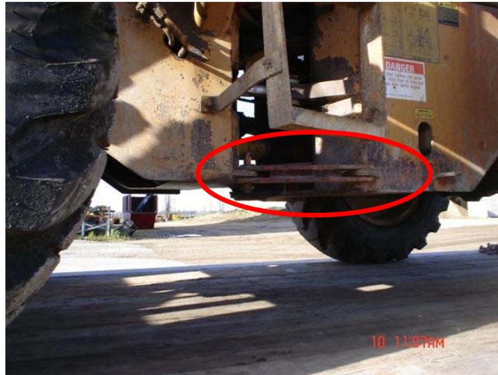
Véhicule équipé de goupilles de verrouillage
